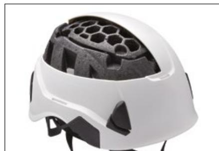
La coque interne des casques STRATO est conçue en deux parties : EPP (polypropylène expansé) et EPS (polystyrène expansé), afin d'offrir plus de légèreté. L'absorption des chocs est réalisée par déformation de la coque interne.
