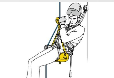
Polyvalents, les descendeurs auto-freinants peuvent être utilisés à la fois en descente et pour de courtes remontées sur corde.
