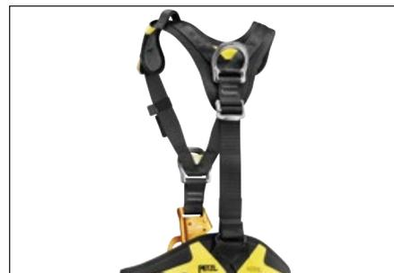
Les harnais complets ASTRO BOD FAST sont dotés d'un point d'attache dorsal permettant de connecter un système d'arrêt des chutes. En cas de chute sur ce point, un réglage court de la longueur entre la ceinture et les tours de cuisse permet de reprendre le poids sur les tours de cuisse et ainsi rester plus longtemps suspendu dans le harnais en attendant les secours.
